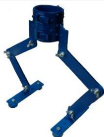
**Устройство «ПАУК-УНИВЕРСАЛ»** обеспечивает крепление излучателя при радиографии. Петельная конструкция охватывающего рентгеновскую трубку хомута с фиксирующим замком позволяют легко установить и зафиксировать в устройстве рентгеновский аппарат. Мощные малогабаритные магниты обеспечивают устойчивость на цилиндрических поверхностях контролируемых объектов. Ножки регулируются по высоте и ориентации магнитов.
