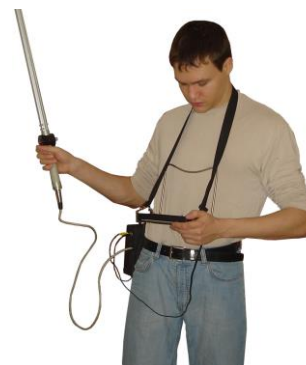
Оператор с видеэндоскопом в руке и видеомонитором, размещенным на груди
